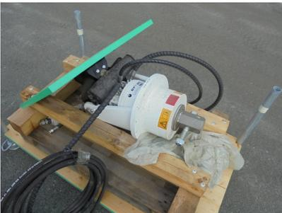
dureté max 20 MPA - 65 KW - Ø max => sol tendre = 1m avec Ø 1200mm, sol intermédiaire = 2m avec Ø 900mm, sol dur = pas possible - max profondeur => sol tendre = 6m avec Ø 500mm, sol intermédiaire = 4m avec Ø 500mm, sol dur = pas possible - 40 à 80 tr/min - nombre de tours corrects => 80 tr/min pour Ø 300mm, 60 tr/min pour Ø 600mm, 40 tr/min pour Ø 1000mm
