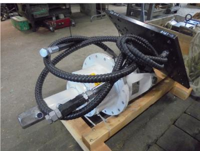
dureté max 40 MPA - 110 KW - Ø max => sol tendre = 2m avec Ø 1500mm, sol intermédiaire = 2m avec Ø 1200mm, sol dur = 2m avec Ø 800mm - max profondeur => sol tendre = 7m avec Ø 600mm, sol intermédiaire = 4m avec Ø 700mm, sol dur = 2m avec Ø 800mm - 38 à 75 tr/min - nombre de tours corrects => 70 tr/min pour Ø 300mm, 60 tr/min pour Ø 600mm, 40 tr/min pour Ø 1000mm, 25 tr/min pour Ø 1500mm
