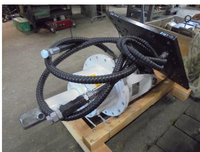
dureté max 40 MPa - 110 KW - Ø max => sol tendre = 2m avec Ø 1500mm, sol intermédiaire = 2m avec Ø 1200mm, sol dur = 2m avec Ø 800mm - max profondeur => sol tendre = 7m avec Ø 600mm, sol intermédiaire = 4m avec Ø 700mm, sol dur = 2m avec Ø 800mm - 38 à 75 tr/min - nombre de tours corrects => 70 tr/min pour Ø 300mm, 60 tr/min pour Ø 600mm, 40 tr/min pour Ø 1000mm, 25 tr/min pour Ø 1500mm
