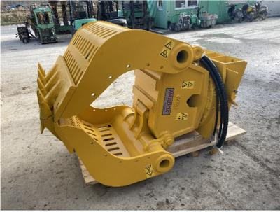
**190-4005-0 Grappin - rocher - 3'870 kg - ouverture 3'050 mm - p/rétro de 45 à 65 to**
