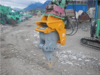
**541-151-1 Dent ripper vibrante - 2'300 kg - pour 18-24 to**
