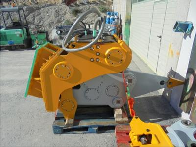
**541-81-1 Dent ripper vibrante - 885 kg - pour 8-12 to**
