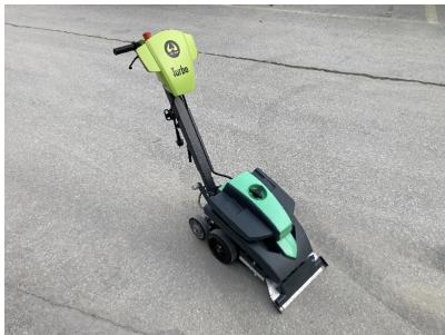
Poids avec contre-poids principal + 1x contre-poids additionnel : 157 kg
