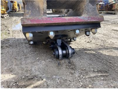
Poids de la plaque avec biellette (sans crochet, sans attache) : 270 kg
