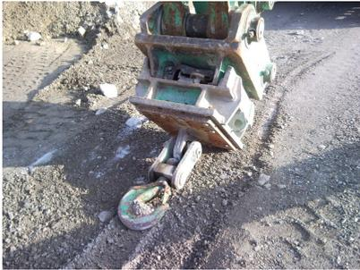
Poids de la plaque avec biellette et crochet (sans attache) : 120 kg
