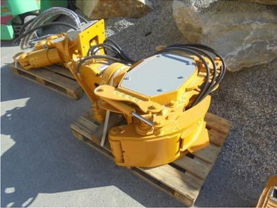
besoin d'une ligne électrique sur la pelle pour la 3ème fonction - VT
