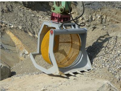
**198-2015-1 Sortierkübel - drehend - 1250 kg - 2.00 m3 - für Bagger von 15 bis 20 To**
