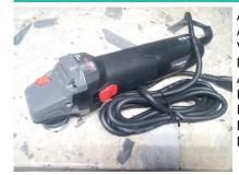
2,4 kg Arbeitsgewicht Abmessungen über alles (LxlxHx) 300x75x100 mm Versorgung Motor électrique 220 V Nominalspannung Aufgenommene Nominalstärke 5,5 A Frequenz 50/60 Hz Innendurchmesser Leitung min. --- mm Druck --- bar Drehgeschwindigkeit 11000 tr/min
