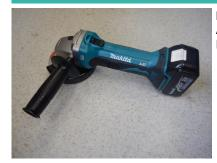
Nominalspannung 220 V Aufgenommene Nominalstärke 3.8 A Frequenz 50/60 Hz
