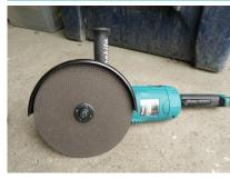
Arbeitsgewicht 5.8 kg Abmessungen über alles (LxlxHx) 473x---x--- mm Versorgung Motor électrique Nominalspannung 230 V Aufgenommene Nominalstärke 10 A Frequenz 50-60 Hz Innendurchmesser Leitung min. --- mm Druck --- bar Drehgeschwindigkeit --- tr/min
