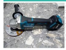
Arbeitsgewicht 3,1 kg Abmessungen über alles (LxlxHx) --- mm électrique Versorgung Motor Nominalspannung 18 V Aufgenommene Nominalstärke --- A Frequenz --- Hz Innendurchmesser Leitung min. --- mm Druck --- bar Drehgeschwindigkeit 8500 tr/min
