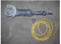
Arbeitsgewicht Versorgung Motor Drehgeschwindigkeit 2.1 kg électrique 11000 tr/min
