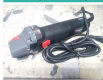
Arbeitsgewicht 2,4 kg 300x75x100 mm Abmessungen über alles (LxlxHx) Versorgung Motor électrique Nominalspannung 220 V Aufgenommene Nominalstärke 5.5 A Frequenz 50/60 Hz Innendurchmesser Leitung min. --- mm Druck --- bar
