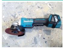
Arbeitsgewicht Versorgung Motor Nominalspannung Drehgeschwindigkeit 3.1 kg électrique 18 V 8500 tr/min
