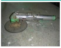
Arbeitsgewicht Drehgeschwindigkeit 1.8 kg 4500 tr/min
