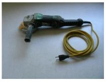
Arbeitsgewicht Versorgung Motor Drehgeschwindigkeit 2.1 kg électrique 11000 tr/min
