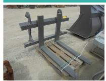
Arbeitsgewicht 196 kg Transportlänge (über alles) 1470 mm Transportbreite (über alles) 1520 mm Transporthöhe (über alles) 970 mm Hebekapazität (mm) ??? to Marke der Aufhängung volvo Typ der Aufhängung 111-52-5 Schnellwechsler oui Anpassung möglich auf Maschine ??? to
