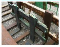
Arbeitsgewicht 125 kg Transportlänge (über alles) 1220 mm Transportbreite (über alles) 1200 mm Transporthöhe (über alles) 700 mm Hebekapazität (mm) 1 à 400mm to Marke der Aufhängung Kramer Typ der Aufhängung 111-52-11 Schnellwechsler oui Anpassung möglich auf Maschine 2 to
