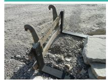
Arbeitsgewicht 430 kg Transportlänge (über alles) 1285 mm Transportbreite (über alles) 1260 mm Transporthöhe (über alles) ??? mm Hebekapazität (mm) 5 to Marke der Aufhängung Volvo Typ der Aufhängung 111-52-5 Schnellwechsler oui Anpassung möglich auf Maschine 8 to
