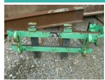
Arbeitsgewicht ??? kg Transportlänge (über alles) 1200 mm Transportbreite (über alles) 1050 mm Transporthöhe (über alles) 700 mm Hebekapazität (mm) ??? to Marke der Aufhängung Kramer Typ der Aufhängung 111-52-12 Schnellwechsler oui Anpassung möglich auf Maschine 7 to
