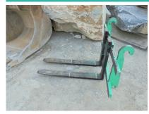
Arbeitsgewicht 290 kg Transportlänge (über alles) 1070 mm Transportbreite (über alles) 1450 mm
