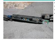
Transportgewicht95 kgTransportlänge (über alles)3000 mmTransportbreite (über alles)460 mmTransporthöhe (über alles)255 mm
