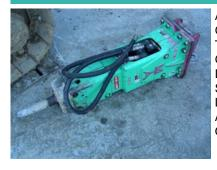
Arbeitsgewicht 280 kg Gewicht ohne Aufhängung 230 kg Transporthöhe (über alles) 1500 mm Gewicht Werkzeug 15 kg **Durchmesser Werkzeug** 65 mm Schlagzahl pro Minute 500-900 Litermenge Öl (min/max) 40-75 lt/min Arbeitsdruck (min/max) 110-120 bar Optimale Anpassung auf Maschine 3.5 à 5 to
