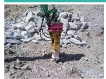
390 kg Arbeitsgewicht Gewicht ohne Aufhängung 305 kg Transporthöhe (über alles) 1380 mm Gewicht Werkzeug 20 kg Durchmesser Werkzeug 75 mm Schlagzahl pro Minute 600-1340 Energieklasse pro Schlag 850 joules Litermenge Öl (min/max) 50-80 lt/min 105-130 bar Arbeitsdruck (min/max) Optimale Anpassung auf Maschine 4 à 8.5 to
