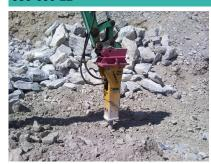
Arbeitsgewicht 390 kg Gewicht ohne Aufhängung 305 kg Transporthöhe (über alles) 1380 mm Gewicht Werkzeug 20 kg Durchmesser Werkzeug 75 mm Schlagzahl pro Minute 600-1340 850 joules Energieklasse pro Schlag Litermenge Öl (min/max) 50-80 lt/min Arbeitsdruck (min/max) 105-130 bar Optimale Anpassung auf Maschine 4 à 8.5 to
