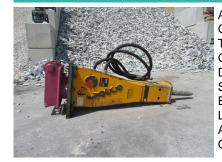
Arbeitsgewicht 230 kg Gewicht ohne Aufhängung 190 kg 1400 mm Transporthöhe (über alles) Gewicht Werkzeug 10 kg Durchmesser Werkzeug 56 mm Schlagzahl pro Minute 470-1340 Energieklasse pro Schlag 450 joules Litermenge Öl (min/max) 30-60 lt/min Arbeitsdruck (min/max) 105-125 bar Optimale Anpassung auf Maschine 2.5 à 5 to
