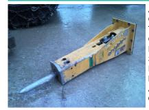
Arbeitsgewicht 160 kg Gewicht ohne Aufhängung 130 kg 1200 mm Transporthöhe (über alles) Gewicht Werkzeug 7 kg Durchmesser Werkzeug 48 mm Schlagzahl pro Minute 610-1570 Energieklasse pro Schlag 240 joules Litermenge Öl (min/max) 25-45 lt/min Arbeitsdruck (min/max) 105-125 bar Optimale Anpassung auf Maschine 2 à 4 to
