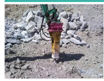
Arbeitsgewicht Gewicht ohne Aufhängung Transporthöhe (über alles) Gewicht Werkzeug Durchmesser Werkzeug Schlagzahl pro Minute Energieklasse pro Schlag Litermenge Öl (min/max) Arbeitsdruck (min/max) 390 kg 305 kg 1380 mm 20 kg 75 mm 530-1170 720 joules 50-80 lt/min 105-130 bar
