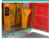
Arbeitsgewicht 300 kg Gewicht ohne Aufhängung 270 kg Transporthöhe (über alles) 1500 mm Gewicht Werkzeug 15 kg **Durchmesser Werkzeug** 65 mm Schlagzahl pro Minute 660-1370 610 joules Energieklasse pro Schlag Litermenge Öl (min/max) 50-80 lt/min Arbeitsdruck (min/max) 105-125 bar Optimale Anpassung auf Maschine 3.5 à 6.5 to
