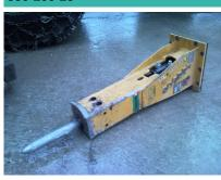
Arbeitsgewicht 160 kg Gewicht ohne Aufhängung 130 kg Transporthöhe (über alles) 1200 mm 7 kg Gewicht Werkzeug Durchmesser Werkzeug 48 mm Schlagzahl pro Minute 700-1800 Energieklasse pro Schlag 300 joules Litermenge Öl (min/max) 25-45 lt/min Arbeitsdruck (min/max) 105-125 bar Optimale Anpassung auf Maschine 2 à 4 to
