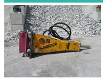
Arbeitsgewicht 230 kg 190 kg Gewicht ohne Aufhängung Transporthöhe (über alles) 1400 mm Gewicht Werkzeug 10 kg Durchmesser Werkzeug 56 mm Schlagzahl pro Minute 470-1340 Energieklasse pro Schlag 450 joules Litermenge Öl (min/max) 30-60 lt/min Arbeitsdruck (min/max) 105-125 bar Optimale Anpassung auf Maschine 2.5 à 5 to
