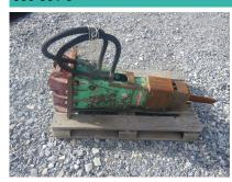
Arbeitsgewicht 180 kg Gewicht ohne Aufhängung 130 kg Transporthöhe (über alles) 1400 mm Gewicht Werkzeug 10 ka Durchmesser Werkzeug 56 mm Schlagzahl pro Minute 700-1100 330 joules Energieklasse pro Schlag Litermenge Öl (min/max) 25-40 lt/min Optimale Anpassung auf Maschine 1.5 - 5 to
