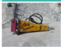
Arbeitsgewicht 230 kg Gewicht ohne Aufhängung 190 kg Transporthöhe (über alles) 1400 mm Gewicht Werkzeug 10 kg **Durchmesser Werkzeug** 56 mm Schlagzahl pro Minute 470-1340 Energieklasse pro Schlag 450 joules Litermenge Öl (min/max) 30-60 lt/min Arbeitsdruck (min/max) 105-125 bar Optimale Anpassung auf Maschine 2.5 à 5 to
