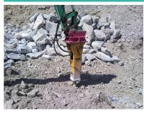
Arbeitsgewicht 390 kg Gewicht ohne Aufhängung 305 kg 1380 mm Transporthöhe (über alles) Gewicht Werkzeug 20 kg Durchmesser Werkzeug 75 mm Schlagzahl pro Minute 600-1340 Energieklasse pro Schlag 850 joules Litermenge Öl (min/max) 50-80 lt/min Arbeitsdruck (min/max) 105-130 bar Optimale Anpassung auf Maschine 4 à 8.5 to
