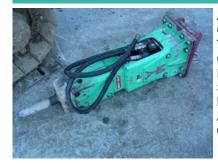
Arbeitsgewicht 280 kg Gewicht ohne Aufhängung 230 kg 1500 mm Transporthöhe (über alles) Gewicht Werkzeug 15 kg Durchmesser Werkzeug 65 mm Schlagzahl pro Minute 500-900 Litermenge Öl (min/max) 40-75 lt/min Arbeitsdruck (min/max) 110-120 bar Optimale Anpassung auf Maschine 3.5 à 5 to
