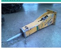
Arbeitsgewicht 160 kg 130 kg Gewicht ohne Aufhängung Transporthöhe (über alles) 1200 mm 7 kg Gewicht Werkzeug Durchmesser Werkzeug 48 mm Schlagzahl pro Minute 700-1800 Energieklasse pro Schlag 300 joules Litermenge Öl (min/max) 25-45 lt/min Arbeitsdruck (min/max) 105-125 bar Optimale Anpassung auf Maschine 2 à 4 to
