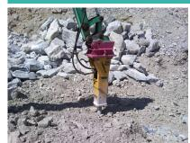
Arbeitsgewicht 390 kg Gewicht ohne Aufhängung 305 kg Transporthöhe (über alles) 1380 mm Gewicht Werkzeug 20 kg Durchmesser Werkzeug 75 mm Schlagzahl pro Minute 530-1170 Energieklasse pro Schlag 720 joules Litermenge Öl (min/max) 50-80 lt/min Arbeitsdruck (min/max) 105-130 bar Optimale Anpassung auf Maschine 4 à 8.5 to
