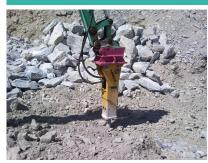
Arbeitsgewicht 390 kg Gewicht ohne Aufhängung 305 kg Transporthöhe (über alles) 1380 mm Gewicht Werkzeug 20 kg Durchmesser Werkzeug 75 mm Schlagzahl pro Minute 530-1170 Energieklasse pro Schlag 720 joules Litermenge Öl (min/max) 50-80 lt/min Arbeitsdruck (min/max) 105-130 bar Optimale Anpassung auf Maschine 4 à 8.5 to
