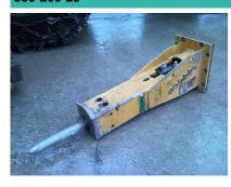
Arbeitsgewicht 160 kg Gewicht ohne Aufhängung 130 kg 1200 mm Transporthöhe (über alles) Gewicht Werkzeug 7 kg Durchmesser Werkzeug 48 mm Schlagzahl pro Minute 700-1800 Energieklasse pro Schlag 300 joules Litermenge Öl (min/max) 25-45 lt/min Arbeitsdruck (min/max) 105-125 bar Optimale Anpassung auf Maschine 2 à 4 to
