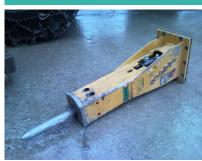
Arbeitsgewicht 160 kg Gewicht ohne Aufhängung 130 kg Transporthöhe (über alles) 1200 mm Gewicht Werkzeug 7 kg **Durchmesser Werkzeug** 48 mm Schlagzahl pro Minute 700-1800 Energieklasse pro Schlag 300 joules Litermenge Öl (min/max) 25-45 lt/min Arbeitsdruck (min/max) 105-125 bar Optimale Anpassung auf Maschine 2 à 4 to
