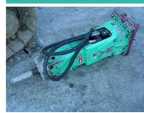
Arbeitsgewicht 280 kg Gewicht ohne Aufhängung 250 kg Transporthöhe (über alles) 1500 mm Gewicht Werkzeug 15 kg **Durchmesser Werkzeug** 65 mm Schlagzahl pro Minute 600-1000 Energieklasse pro Schlag 550 joules Litermenge Öl (min/max) 40-65 lt/min Arbeitsdruck (min/max) 110-120 bar Optimale Anpassung auf Maschine 3.5 à 5 to
