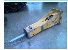
Arbeitsgewicht 160 kg Gewicht ohne Aufhängung 130 kg 1200 mm Transporthöhe (über alles) Gewicht Werkzeug 7 kg Durchmesser Werkzeug 48 mm Schlagzahl pro Minute 700-1800 Energieklasse pro Schlag 300 joules Litermenge Öl (min/max) 25-45 lt/min Arbeitsdruck (min/max) 105-125 bar Optimale Anpassung auf Maschine 2 à 4 to
