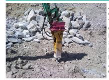
Arbeitsgewicht 390 kg Gewicht ohne Aufhängung 305 kg 1380 mm Transporthöhe (über alles) Gewicht Werkzeug 20 kg Durchmesser Werkzeug 75 mm Schlagzahl pro Minute 600-1340 Energieklasse pro Schlag 850 joules Litermenge Öl (min/max) 50-80 lt/min Arbeitsdruck (min/max) 105-130 bar Optimale Anpassung auf Maschine 4 à 8.5 to
