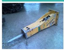
Arbeitsgewicht 160 kg Gewicht ohne Aufhängung 130 kg Transporthöhe (über alles) 1200 mm Gewicht Werkzeug 7 kg Durchmesser Werkzeug 48 mm Schlagzahl pro Minute 610-1570 Energieklasse pro Schlag 240 joules Litermenge Öl (min/max) 25-45 lt/min Arbeitsdruck (min/max) 105-125 bar Optimale Anpassung auf Maschine 2 à 4 to
