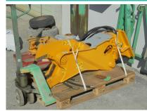
Gewicht ohne Aufhängung Länge ohne Aufhängung Backenöffnung Backenlänge Litermenge Öl (min/max) Arbeitsdruck (min/max) 300 kg 1330 mm 265 mm 230 mm 80/100 lt/min 220 bar
