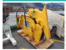
Gewicht ohne Aufhängung 2680 kg Länge ohne Aufhängung 3330 mm End-Spannkraft 154 to Messer-Spannkraft 296 to Messerlänge 400 mm Schnittdurchmesser max (Metall) 12 mm Backenöffnung 350 mm Backenlänge 630 mm Backenbreite fest 350 mm Litermenge Öl (min/max) 200/300 lt/min Arbeitsdruck (min/max) 310 bar Anpassung möglich auf Maschine 25-35 to
