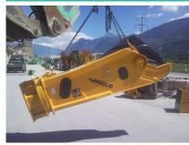
Gewicht ohne Aufhängung 1800 kg Länge ohne Aufhängung 2724 mm End-Spannkraft 120 to Messerlänge 500 mm Backenöffnung 550 mm Backenbreite fest 450 mm Litermenge Öl (min/max) 100/200 lt/min Arbeitsdruck (min/max) 400 bar Anpassung möglich auf Maschine 20 to
