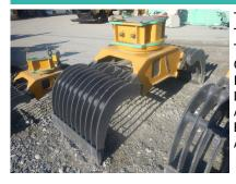
Transportlänge (über alles) 2700 mm Transportbreite (über alles) 1500 mm Transporthöhe (über alles) 1100 mm Öffnung 2700 mm Inhalt 1200 lt Litermenge Öl (min/max) 130 lt/min 350 bar Arbeitsdruck (min/max) Bohrtyp MTA Anpassung möglich auf Maschine 23 à 30 to
