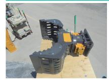
Transportlänge (über alles) 1100 mm Transportbreite (über alles) 500 mm Transporthöhe (über alles) 810 mm Öffnung 900 mm Inhalt 60 It Litermenge Öl (min/max) 25 lt/min Arbeitsdruck (min/max) 245 bar Bohrtyp MTA BF Anpassung möglich auf Maschine 1.8 à 2.5 to
