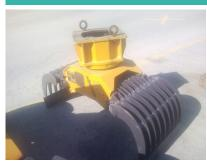
Transportlänge (über alles) 1700 mm Transportbreite (über alles) 1000 mm Transporthöhe (über alles) 700 mm Öffnung 1500 mm Inhalt 170 lt Litermenge Öl (min/max) 30 lt/min Arbeitsdruck (min/max) 300 bar Bohrtyp MTA E7 Anpassung möglich auf Maschine 3 à 6 to
