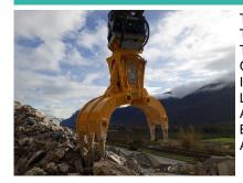
Transportlänge (über alles) 2900 mm Transportbreite (über alles) 1050 mm Transporthöhe (über alles) 800 mm Öffnung 1750 mm Inhalt 900 It Litermenge Öl (min/max) 180/250 lt/min Arbeitsdruck (min/max) 310 bar Bohrtyp MTA I-J Anpassung möglich auf Maschine 20-35 to
