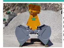
Transportlänge (über alles) 1940 mm Transportbreite (über alles) 1800 mm Transporthöhe (über alles) 1000 mm Öffnung 1900 mm Inhalt 800 It Litermenge Öl (min/max) 570 lt/min Arbeitsdruck (min/max) 280/300 bar Bohrtyp MTA FHI Anpassung möglich auf Maschine 20-40 to
