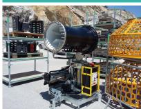
1450x1600x2000 mm - Jet à 35m Spécifications éléctrique : Ventilateur 2,2-3kW - Pompe 1,5-3kW - 1x Prise 230 16A Spécifications H2O : Pression 2min/5max - 20 Buses - 20bar - 1200 L/h de débit connection 1" BSP mâle - température max/max de l'eau 25°C/5°C
