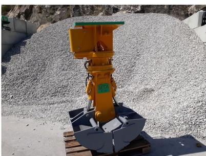
**522-150-0 (NE PAS LOUER) Primär-Abbruchzange - 1500 kg\* - 815 mm - drehbar - für 14-24 to**
