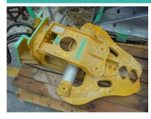
Gewicht ohne Aufhängung 300 kg Länge ohne Aufhängung 1165 mm End-Spannkraft 22 to Messer-Spannkraft 80 to Schnittdurchmesser max (Metall) 18 mm Backenöffnung 385 mm Backenbreite fest 35 mm Litermenge Öl (min/max) 60/80 lt/min Arbeitsdruck (min/max) 210 bar
