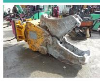
??? mm Länge ohne Aufhängung 100 to End-Spannkraft Messer-Spannkraft 375 to Schnittdurchmesser max (Metall) 50 mm Backenöffnung 635 mm Backenlänge 750 mm Backenbreite fest 415 mm Litermenge Öl (min/max) 200/300 lt/min Arbeitsdruck (min/max) 310 bar
