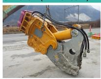
Gewicht ohne Aufhängung ??? kg Länge ohne Aufhängung 2470 mm End-Spannkraft 130 to Messer-Spannkraft 720 to Messerlänge 785 mm Schnittdurchmesser max (Metall) 55 mm Backenöffnung 550 mm Backenlänge 785 mm Backenbreite fest 475 mm Litermenge Öl (min/max) 350/350 lt/min Arbeitsdruck (min/max) 310 bar
