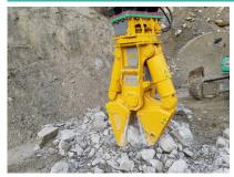
Gewicht ohne Aufhängung 2800 kg Länge ohne Aufhängung 2310 mm **End-Spannkraft** 110 to Messer-Spannkraft 450 to Messerlänge 590 mm Schnittdurchmesser max (Metall) 45 mm Backenöffnung 550 mm Backenlänge xxx/800 mm Backenbreite fest 385/530 mm Litermenge Öl (min/max) 200/300 lt/min Arbeitsdruck (min/max) 350 bar Anpassung möglich auf Maschine 23-40 to
