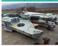
Gewicht ohne Aufhängung ??? kg Länge ohne Aufhängung 2525 mm End-Spannkraft 100 to Messer-Spannkraft 700 to Schnittdurchmesser max (Metall) 50 mm Backenöffnung 850 mm Backenlänge 815 mm Backenbreite fest 410 mm Litermenge Öl (min/max) 250/350 lt/min Arbeitsdruck (min/max) 310 bar
