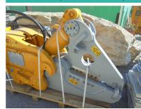
Gewicht ohne Aufhängung ??? kg Länge ohne Aufhängung 2455 mm End-Spannkraft 80 to Messer-Spannkraft 510 to Schnittdurchmesser max (Metall) 45 mm Backenöffnung 810 mm Backenlänge 800 mm Backenbreite fest 350 mm Litermenge Öl (min/max) 200/300 lt/min Arbeitsdruck (min/max) 310 bar
