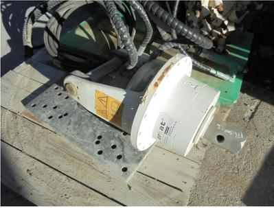
dureté max 15 MPA - 45 KW - Ø max => sol tendre = 1m avec Ø 1000mm, sol intermédiaire = 2m avec Ø 700mm, sol dur = pas possible - max profondeur => sol tendre = 5m avec Ø 300mm, sol intermédiaire = 3m avec Ø 300mm, sol dur = pas possible - 53 à 90 tr/min - nombre de tours corrects => 80 tr/min pour Ø 300mm, 60 tr/min pour Ø 600mm, 40 tr/min pour Ø 1000mm
