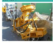
Gewicht ohne Aufhängung Litermenge Öl (min/max) Arbeitsdruck (min/max) Anzahl Leitungen auf Maschine 930 kg -/20 rotation lt/min -/175 rotation bar
