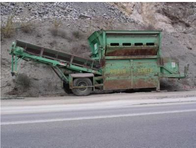
Largeur du convoyeur 1.5 m - Capacité du réservoir 230 lt - Autorisation spéciale - puissance moteur 40 kW/54HP
