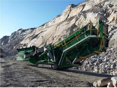
Sortie des matériaux => à l'avant le fin - à droite le gros - à gauche le moyen
