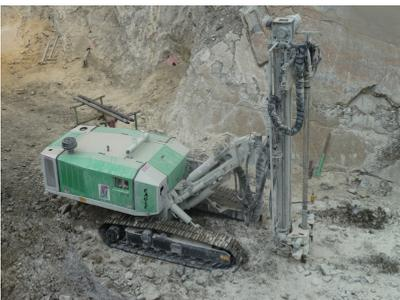
Poids 6'000kg - Longueur 5'700mm - Largeur 1'650mm - Hauteur avec bras à l'horizontal 2'400mm - Hauteur avec bras incliné 2'250mm
