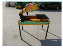
Poids 100 kg 1110 mm Longueur transport (hors-tout) Largeur transport (hors-tout) 630 mm Hauteur transport (hors-tout) 700 mm Longueur de coupe 410 mm Profondeur de coupe ??? mm Diamètre du disque 350 mm Alimentation moteur électrique Tension nominale 230 V Intensité absorbée nominale 10 A
