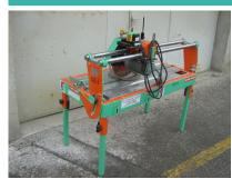
Poids 120 kg Longueur transport (hors-tout) 1400 mm Largeur transport (hors-tout) 680 mm Hauteur transport (hors-tout) 1320 mm Longueur de coupe 1000 mm Profondeur de coupe 110 mm 350 mm Diamètre du disque Alimentation moteur électrique
