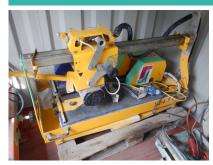
114 kg 1300 mm Longueur transport (hors-tout) Largeur transport (hors-tout) 750 mm Hauteur transport (hors-tout) 850 mm Longueur de coupe 800 mm Profondeur de coupe ??? mm Diamètre du disque 350 mm Alimentation moteur Electrique Tension nominale 230 V Intensité absorbée nominale 13.5 A
