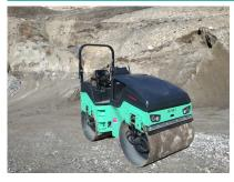
Poids transport 4200 kg Longueur transport (hors-tout) 2840 mm Largeur transport (hors-tout) 1390 mm Hauteur transport (hors-tout) 2700 mm Force centrifuge 39/48 Kn Position du machiniste siège Alimentation moteur diesel Type de transmission hydro Immatriculation oui
