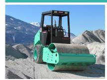
Poids transport 4900 kg 4030 mm Longueur transport (hors-tout) Largeur transport (hors-tout) 1542 mm Hauteur transport (hors-tout) 2480 mm Force centrifuge 100 Kn Position du machiniste siège
