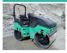
Poids transport 4500 kg Longueur transport (hors-tout) 2840 mm Largeur transport (hors-tout) 1468 mm Hauteur transport (hors-tout) 2700 mm Force centrifuge 45/57 Kn Position du machiniste siège Alimentation moteur diesel hydro Type de transmission Immatriculation oui
