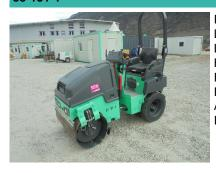
Poids transport 1700 kg Longueur transport (hors-tout) 2194 mm Largeur transport (hors-tout) 1056 mm Hauteur transport (hors-tout) 1663/2340 mm Force centrifuge 8/17 Kn Position du machiniste siège Alimentation moteur Diesel Immatriculation non
