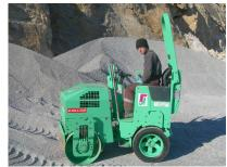
Poids transport Longueur transport (hors-tout) Largeur transport (hors-tout) Hauteur transport (hors-tout) Force centrifuge Alimentation moteur Immatriculation 1670 kg 1890 mm 956 mm 1562/2380 mm 15/7 Kn diesel non
