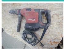
Poids en ordre de marche Dimensions hors-tout (LxlxH) Alimentation moteur Tension nominale Intensité absorbée nominale Fréquence Vitesse de rotation 7.4 kg 497x115x261 mm électrique 230 V 6.8 A 50-60 Hz 282 tr/min
