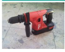
Poids en ordre de marche Dimensions hors-tout (LxlxH) Alimentation moteur Tension nominale Intensité absorbée nominale Fréquence Vitesse de rotation 4.2 kg 330 x 90 x 90 mm électrique 36 V ??? A ??? Hz 1050 tr/min
