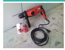
Poids en ordre de marche Dimensions hors-tout (LxlxH) Alimentation moteur Tension nominale Intensité absorbée nominale Fréquence Vitesse de rotation 2.7 kg 352x89x203 mm électrique 230 V ??? A ??? Hz 1200 tr/min
