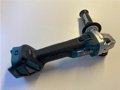
**614-63-0 (NE PAS LOUER) Meuleuse - accu 238-4 - 18V - 3.0kg - 8'500T/min - Ø125mm - avec 123-52/69**
