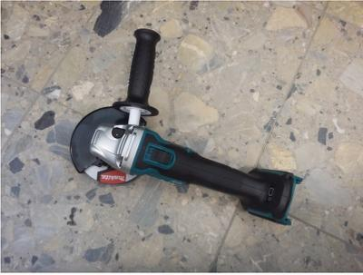
**614-39-0 Meuleuse - accu - 18V - Ø 125 mm - 2.5kg - 8500 T/min**
