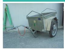
34 kg Poids à vide constructeur Poids total 80 kg Longueur transport (hors-tout) --- mm Largeur transport (hors-tout) --- mm Hauteur transport (hors-tout) --- mm Charge utile/sellette 46 kg Longueur intérieure du pont 800 mm Largeur intérieure du pont 620 mm Crochet de remorquage oui
