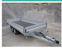
Poids total 3500 kg Longueur transport (hors-tout) 5550 mm Largeur transport (hors-tout) 1910 mm Hauteur transport (hors-tout) 1080 mm Charge utile/sellette 2860 kg Longueur intérieure du pont 4100 mm Largeur intérieure du pont 1850 mm Crochet de remorquage oui VS 275220 N° plaque
