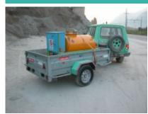
Poids à vide constructeur 270 kg Poids total 1000 kg Longueur transport (hors-tout) 2300 mm Largeur transport (hors-tout) 1350 mm Hauteur transport (hors-tout) 450 mm Charge utile/sellette 720 kg Longueur intérieure du pont 2210 mm Largeur intérieure du pont 1260 mm Crochet de remorquage oui VS 254139 N° plaque
