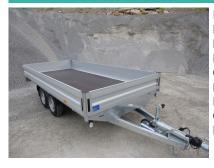
Poids total 3500 kg Longueur transport (hors-tout) 5550 mm Largeur transport (hors-tout) 1910 mm Hauteur transport (hors-tout) 1080 mm Charge utile/sellette 2860 kg Longueur intérieure du pont 4100 mm Largeur intérieure du pont 1850 mm Crochet de remorquage oui N° plaque VS 275219
