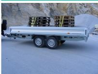
Poids à vide constructeur Poids total Longueur transport (hors-tout) Largeur transport (hors-tout) Hauteur transport (hors-tout) Charge utile/sellette Longueur intérieure du pont Largeur intérieure du pont Crochet de remorquage N° plaque 640 kg 3500 kg 5540 mm 1920 mm 1140 mm 2860 kg 4100 mm 1850 mm oui
