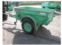
Poids à vide constructeur 460 kg 1500 kg Poids total Longueur transport (hors-tout) 3300 mm Largeur transport (hors-tout) 1500 mm Hauteur transport (hors-tout) 1150 mm Charge utile/sellette 1040 kg Longueur intérieure du pont 1150 mm Largeur intérieure du pont 1800 mm Crochet de remorquage oui N° plaque VS 257523
