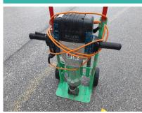
Poids en ordre de marche Dimensions hors-tout (LxlxH) Alimentation moteur Tension nominale Intensité absorbée nominale Fréquence Vitesse de rotation 29.5 kg 650x140x770 mm électrique 230 V --- A 50 Hz --- tr/min
