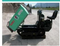
Longueur transport (hors-tout) 2400 mm Largeur transport (hors-tout) 900 mm Hauteur transport (hors-tout) 1345 mm Charge utile (à ras/en tas) 0.35 m3 Charge utile/sellette 1000 kg Garde au sol 120 mm Déversement frontal Position du machiniste siège Chenilles ou pneus chenilles Alimentation moteur diesel
