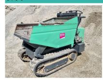
Longueur transport (hors-tout) 1840 mm Largeur transport (hors-tout) 800 mm Hauteur transport (hors-tout) 1250 mm Charge utile (à ras/en tas) 0.33 m3 Charge utile/sellette 500 kg Garde au sol 100 mm Déversement frontal Position du machiniste debout chenilles Chenilles ou pneus Alimentation moteur diesel
