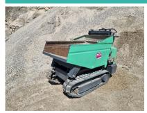
Longueur transport (hors-tout) 1840 mm Largeur transport (hors-tout) 800 mm Hauteur transport (hors-tout) 1250 mm Charge utile (à ras/en tas) 0.33 m3 Charge utile/sellette 500 kg Garde au sol 100 mm Déversement frontal Position du machiniste debout Chenilles ou pneus chenilles Alimentation moteur diesel
