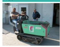
Longueur transport (hors-tout) 2400 mm Largeur transport (hors-tout) 900 mm Hauteur transport (hors-tout) 1345 mm Charge utile (à ras/en tas) 0.35 m3 Charge utile/sellette 1000 kg Garde au sol 120 mm Déversement frontal Position du machiniste siège chenilles Chenilles ou pneus Alimentation moteur diesel
