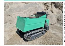
Longueur transport (hors-tout) 1840 mm 800 mm Largeur transport (hors-tout) Hauteur transport (hors-tout) 1250 mm Charge utile (à ras/en tas) 0.33 m3 Charge utile/sellette 500 kg Garde au sol 100 mm Déversement frontal Position du machiniste debout Chenilles ou pneus chenilles Alimentation moteur diesel
