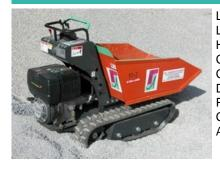
Longueur transport (hors-tout) 1600 mm Largeur transport (hors-tout) 700 mm Hauteur transport (hors-tout) 1020 mm Charge utile (à ras/en tas) 0.2 m3 Charge utile/sellette 500 kg Déversement frontal Position du machiniste debout Chenilles ou pneus chenilles Alimentation moteur diesel
