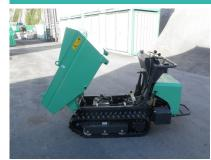
Longueur transport (hors-tout) 1680 mm Largeur transport (hors-tout) 830 mm Hauteur transport (hors-tout) 1290 mm Charge utile/sellette 0.355 kgGarde au sol ~100 mm Déversement avant Position du machiniste debout Chenilles ou pneus Chenilles Alimentation moteur diesel
