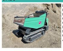
Longueur transport (hors-tout) 1680 mm Largeur transport (hors-tout) 830 mm Hauteur transport (hors-tout) 1290 mm Charge utile/sellette 0.355 kg Garde au sol ~100 mm Déversement avant Position du machiniste debout Chenilles ou pneus Chenilles Alimentation moteur diesel
