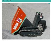
Longueur transport (hors-tout) 1600 mm Largeur transport (hors-tout) 700 mm Hauteur transport (hors-tout) 1020 mm 0.2 m3 Charge utile (à ras/en tas) Charge utile/sellette 500 kg Déversement frontal Position du machiniste debout Chenilles ou pneus chenilles Alimentation moteur diesel
