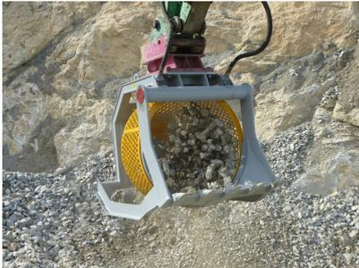
contrôle => entre 18 et 20 tr/min (matériaux doit tomber et non rester coller pendant le tour) - 115/200 bars
