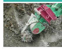
Longueur transport (hors-tout) 965 mm Largeur transport (hors-tout) 680 mm Hauteur transport (hors-tout) 450 mm Diamètre du tambour 450 mm Nombre de burins 44 pce 90 tr/min Vitesse rotation (It/min) Débit d'huile L1 (min/max) 100 lt/min Pression de service L1 (min/max) 350 bar Adaptation optimale s/machine 8-15 to
