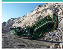
Sortie des matériaux => à l'avant le fin - à droite le gros - à gauche le moyen
