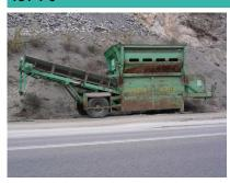
Largeur du convoyeur 1.5 m - Capacité du réservoir 230 lt - Autorisation spéciale - puissance moteur 40 kW/54HP
