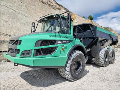
temps de basculement 12 sec - temps de descente 10 sec - angle de basculement 70° -
