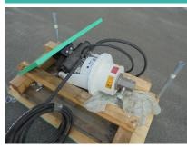
dureté max 20 MPA - 65 KW - Ø max => sol tendre = 1m avec Ø 1200mm, sol intermédiaire = 2m avec Ø 900mm, sol dur = pas possible - max profondeur => sol tendre = 6m avec Ø 500mm, sol intermédiaire = 4m avec Ø 500mm, sol dur = pas possible - 40 à 80 tr/min - nombre de tours corrects => 80 tr/min pour Ø 300mm, 60 tr/min pour Ø 600mm, 40 tr/min pour Ø 1000mm
