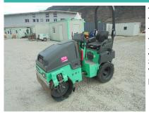
Transportgewicht 1700 kg Transportlänge (über alles) 2194 mm Transportbreite (über alles) 1056 mm Transporthöhe (über alles) 1663/2340 mm Zentrifugalkraft 8/17 Kn Standort des Maschinisten siège Versorgung Motor Diesel Kennzeichen non
