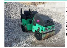
Transportgewicht 1700 kg Transportlänge (über alles) 2194 mm Transportbreite (über alles) 1056 mm Transporthöhe (über alles) 1627/2340 mm Zentrifugalkraft 8/17 Kn Standort des Maschinisten siège Versorgung Motor Diesel Kennzeichen non
