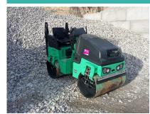
Transportgewicht 1700 kg Transportlänge (über alles) 2194 mm Transportbreite (über alles) 1056 mm Transporthöhe (über alles) 1627/2340 mm Zentrifugalkraft 8/17 Kn Standort des Maschinisten siège Versorgung Motor Diesel Kennzeichen non
