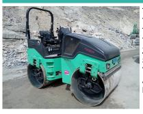
Transportgewicht 4500 kg Transportlänge (über alles) 2840 mm Transportbreite (über alles) 1468 mm Transporthöhe (über alles) 2700 mm Zentrifugalkraft 45/57 Kn Standort des Maschinisten siège Versorgung Motor diesel Antriebstyp hydro Kennzeichen oui
