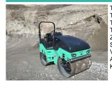
Transportgewicht 4200 kg Transportlänge (über alles) 2840 mm Transportbreite (über alles) 1390 mm Transporthöhe (über alles) 2700 mm Zentrifugalkraft 39/48 Kn Standort des Maschinisten siège Versorgung Motor diesel Antriebstyp hydro Kennzeichen oui
